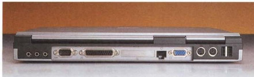
Il retro del notebook: da sinistra, i connettori per l'I/O audio, la porta seriale e la parallela, il connettore RJ 11/45 per il modem V90 e l'interfaccia LAN 10/100 Ethernet integrata, l'uscita VGA esterna, l'uscita TV/Svideo, la porta PS/2 e le due porte seriali USB.
